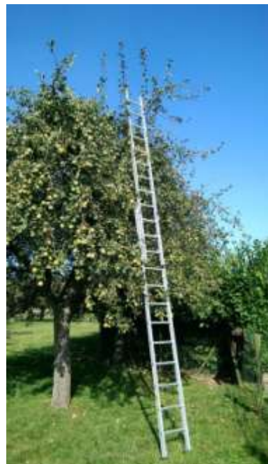
Foto 4: Speciale hoogstamladder: smal, licht en met punten aan de onderkant
